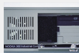
方便维护的防尘过滤装置
