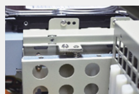
带弹簧减震的硬盘架
