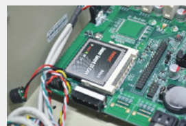
支持电子盘CF卡，搭建稳定的系统
